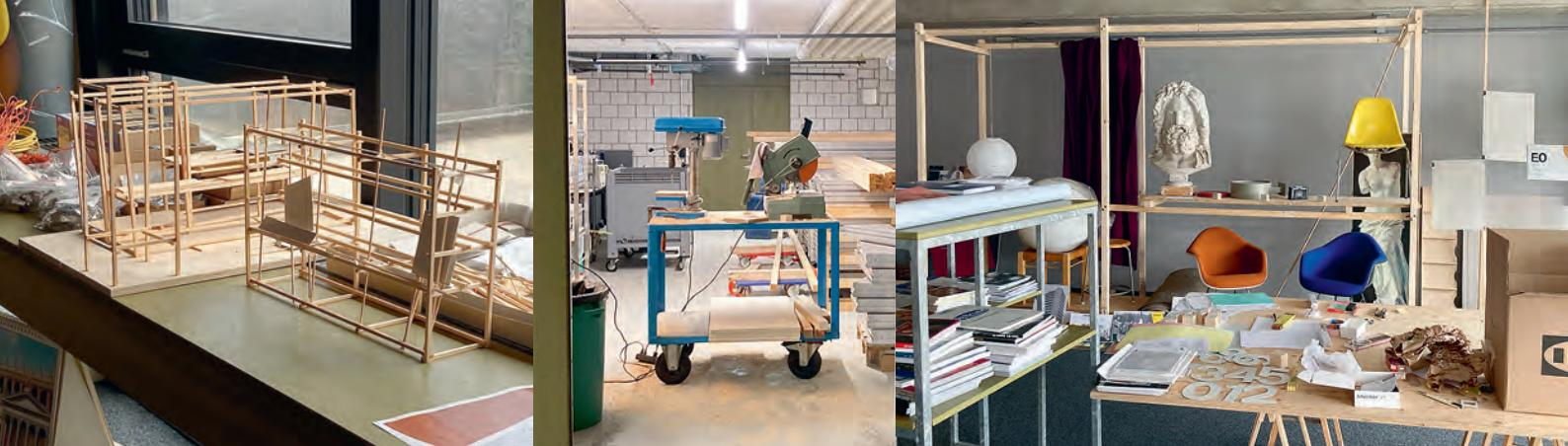
sichtbar verschraubte Primärkonstruktion aus sägerohen Fichtenbalken mit eingesetzten feinen Gipsleisten schafft es, die Diversität der Exponate aus fünf Jahrzehnten übersichtlich zusammenzufassen. Die Grenzen sind also klar gesetzt, bieten aber Raum für eine rollende Planung, ein Reagieren auf eine konzeptuelle Entwicklung.
